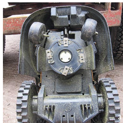
Různá řešení žacíh čepelí – Robomow RS 615 (1) je vybaven dvěma třícípými noži, John Deere Tango E5 series II (2) má řešení podobné běžným sekačkám. Worx WG791E.1 (3) seká pomocí soustavy čtyř žiletkových nožů upevněných na plastovém kole.
